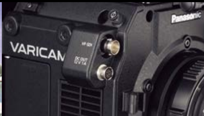
电子寻像器与高清 SDI 及直流电源的接口
